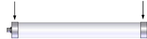
**Achtung:** Das Befestigen der Leuchte über das Schutzglas kann zur Zerstörung des Glaskolbens führen. Bei unsachgemäßer Montage kann keine Garantie gewährleistet werden.
